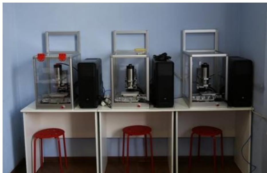
*Рис. 6. Фрезерно-гравировальные станки в ЦМИТ «Нанотехнологии»*
