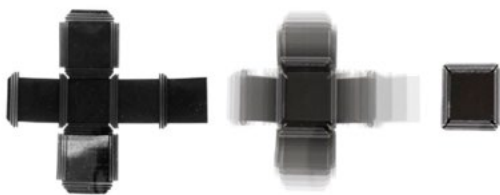
Рис. 1. Простейший пример 4D-печати: плоская поверхность, которая самостоятельно сворачивается в закрытый куб. Self-Assembly Lab, MIT; Stratasys, Ltd.; and Autodesk, Inc.
