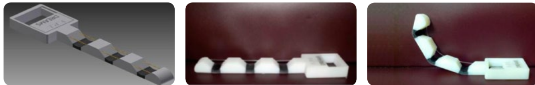
Рис. 2. Палец робота, спроектированный и напечатанный методами аддитивных технологий (слева направо): виртуальное представление в САПР (системе автоматизированного проектирования), напечатанный палец с встроенным силовым проводником, активированное движение пальца
