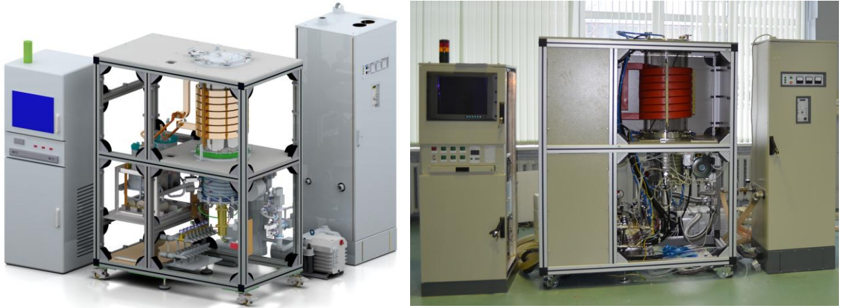
Рис. 3. Модель и реальное исполнение установки для выращивания монокристаллов карбида кремния и отжига эпитаксиальных пластин
