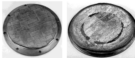
Рис. 4. Магнетронные мишени из TiSi 2 (до распыления и полностью распыленная)
